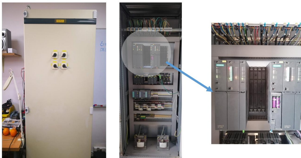
Slika 16. PLC SIEMENS SIMATIC S7-400
