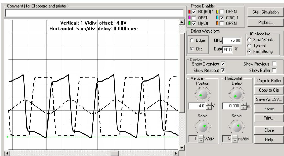
Slika 4.4.34. Potiskivanje refleksija upotrebom malog blokirajućeg kondenzatora
