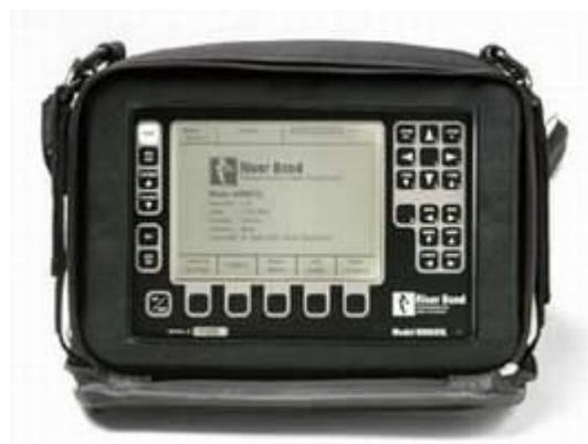
Slika 4.2.4. Reflektometar Model 6000
