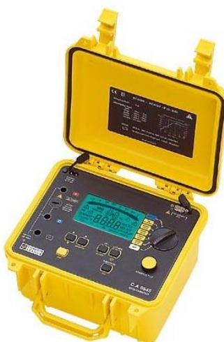
Slika 4.2.1. Merilo otpornosti izolacije
