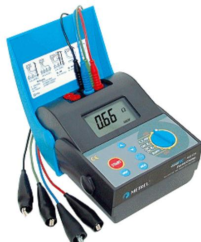
Slika 4.2.2. Merilo otpornosti uzemljenja
