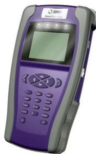
Slika 4.2.13. ADSL tester proizvođača JDSU
