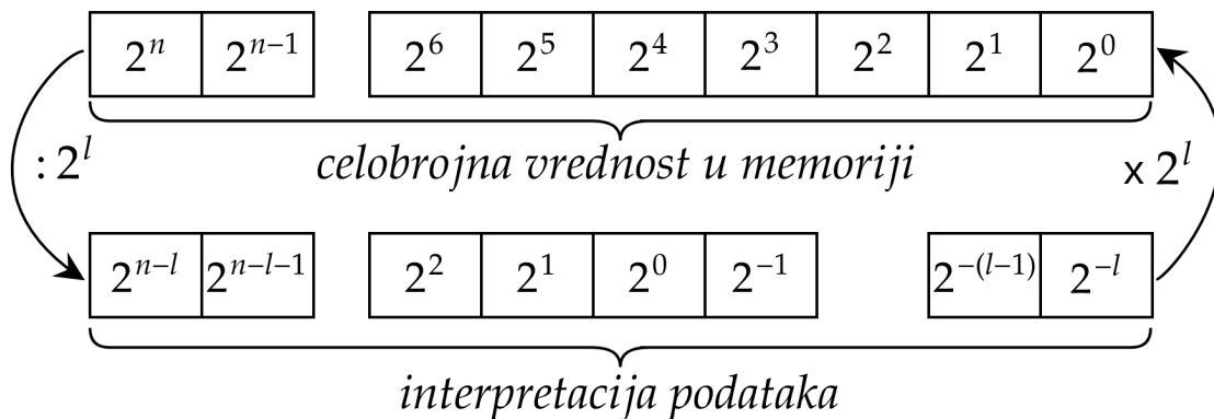
Slika 15: Transformacija podataka iz celobrojnog u decimalni
