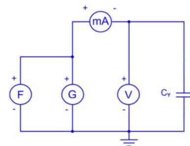
Slika 12.2.4. Merenje kapacitivnosti blok kondenzatora U/I metodom.
