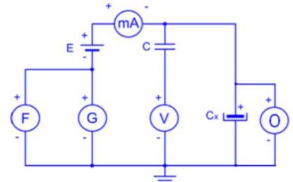
Slika 12.2.2. Merenje kapacitivnosti elektrolitskog kondenzatora U/I metodom naponskim spojem.
