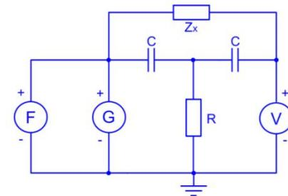
Slika 12.1.3. Merenje induktivnosti dvojnim T mostom.
