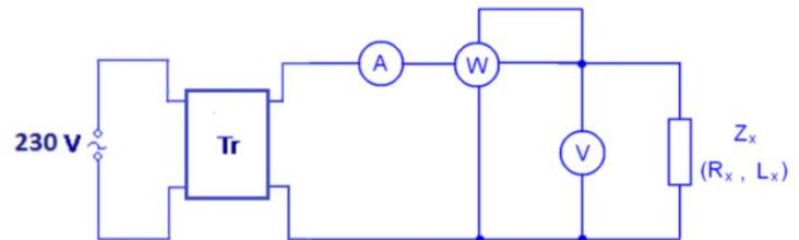
Slika 11.3. Merenje induktivnosti potrošača, vodeći računa o gubicima u jezgru.
