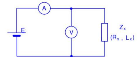
Slika 11.1. Merenje otpornosti induktivnih potrošača jednosmernom strujom.
