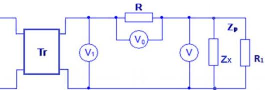
Slika 10.2.1. Merenje aktivne snage i faktora snage metodom tri voltmetra.
