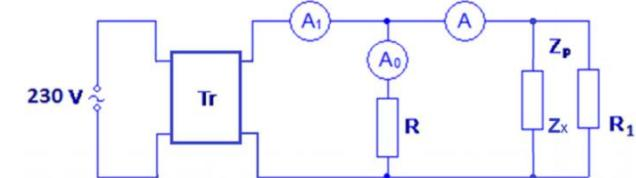
Slika 10.1.1. Merenje aktivne snage i faktora snage metodom tri ampermetra.
