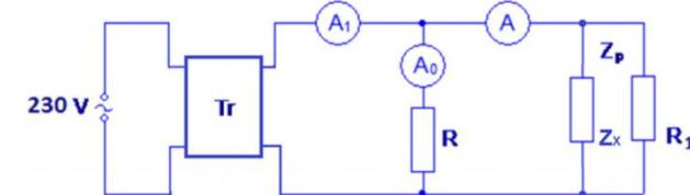
Slika 10.1.1. Merenje aktivne snage i faktora snage metodom tri ampermeta.
