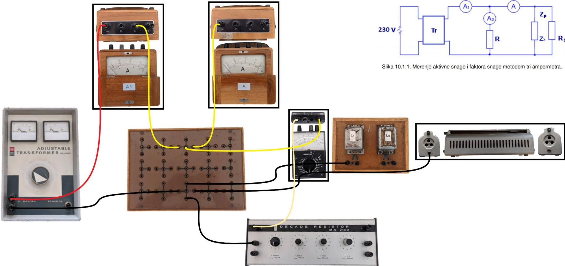
Slika 10.1.1. Merenje aktivne snage i faktora snage metodom tri ampermetra.
