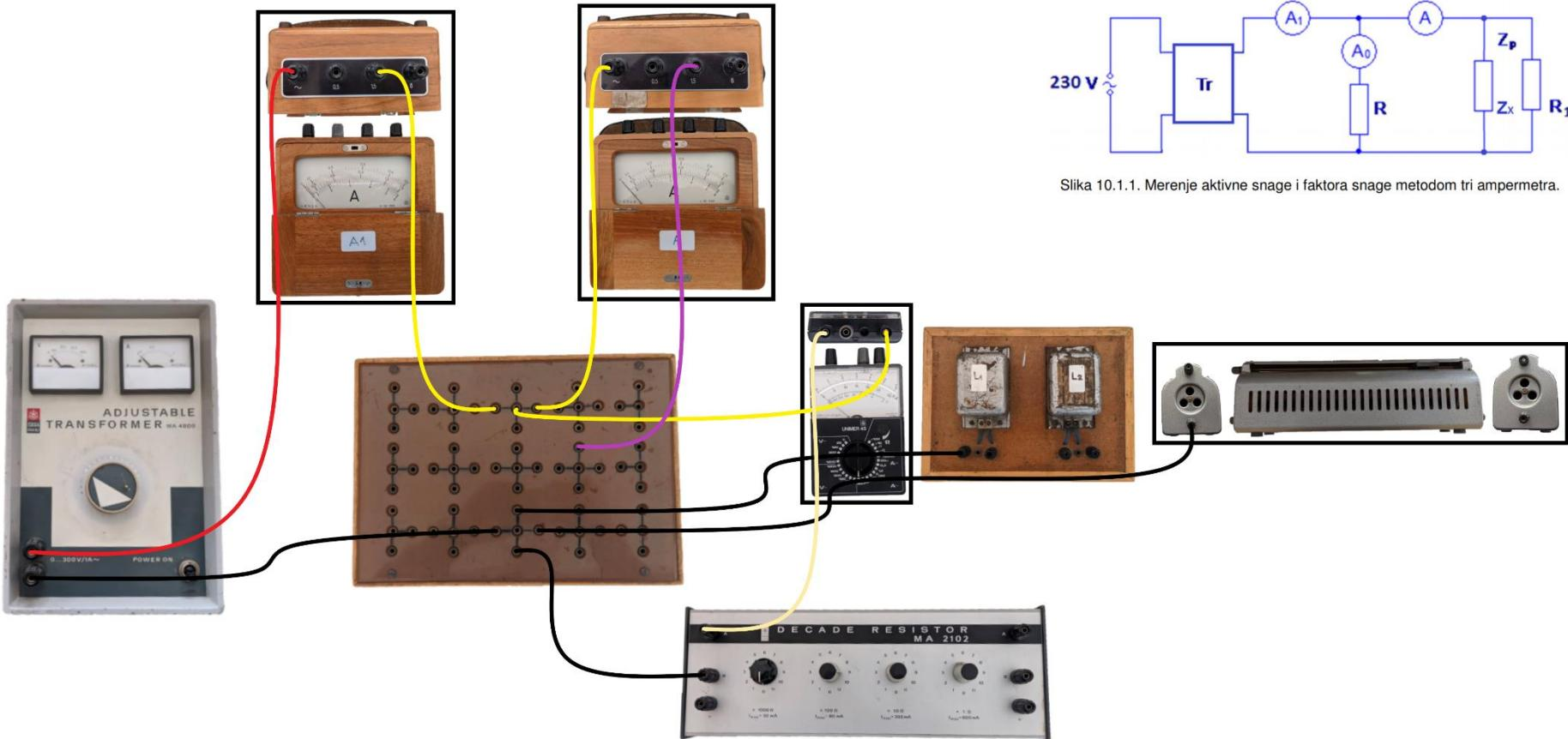
Slika 10.1.1. Merenje aktivne snage i faktora snage metodom tri ampermeta.
