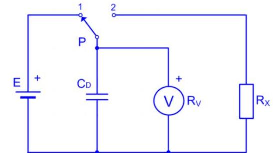
Slika 9.2.1. Merenje velikih otpornosti metodom pražnjenja kondenzatora.
