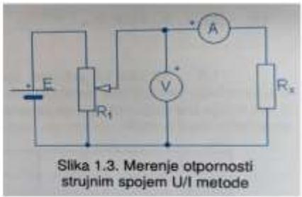
Slika 1.3. Merenje otpornosti strujnim spojem U/I metode
