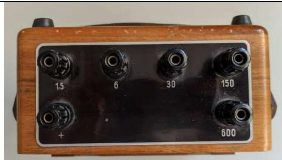
Voltmetar sa više opsega (pet opsega) i više skala (tri skale).
