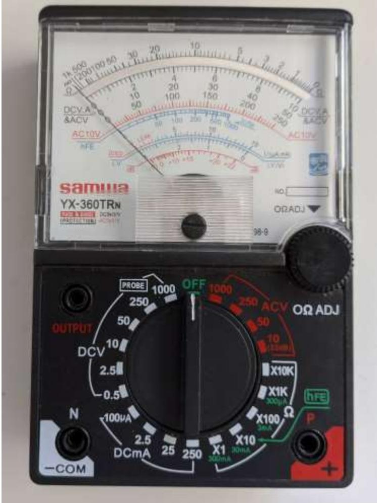
Ovo je multimetar. Namjenjen je za merenje više električnih veličina, DCV, DCmA, ACV, hFE, otpornost.
