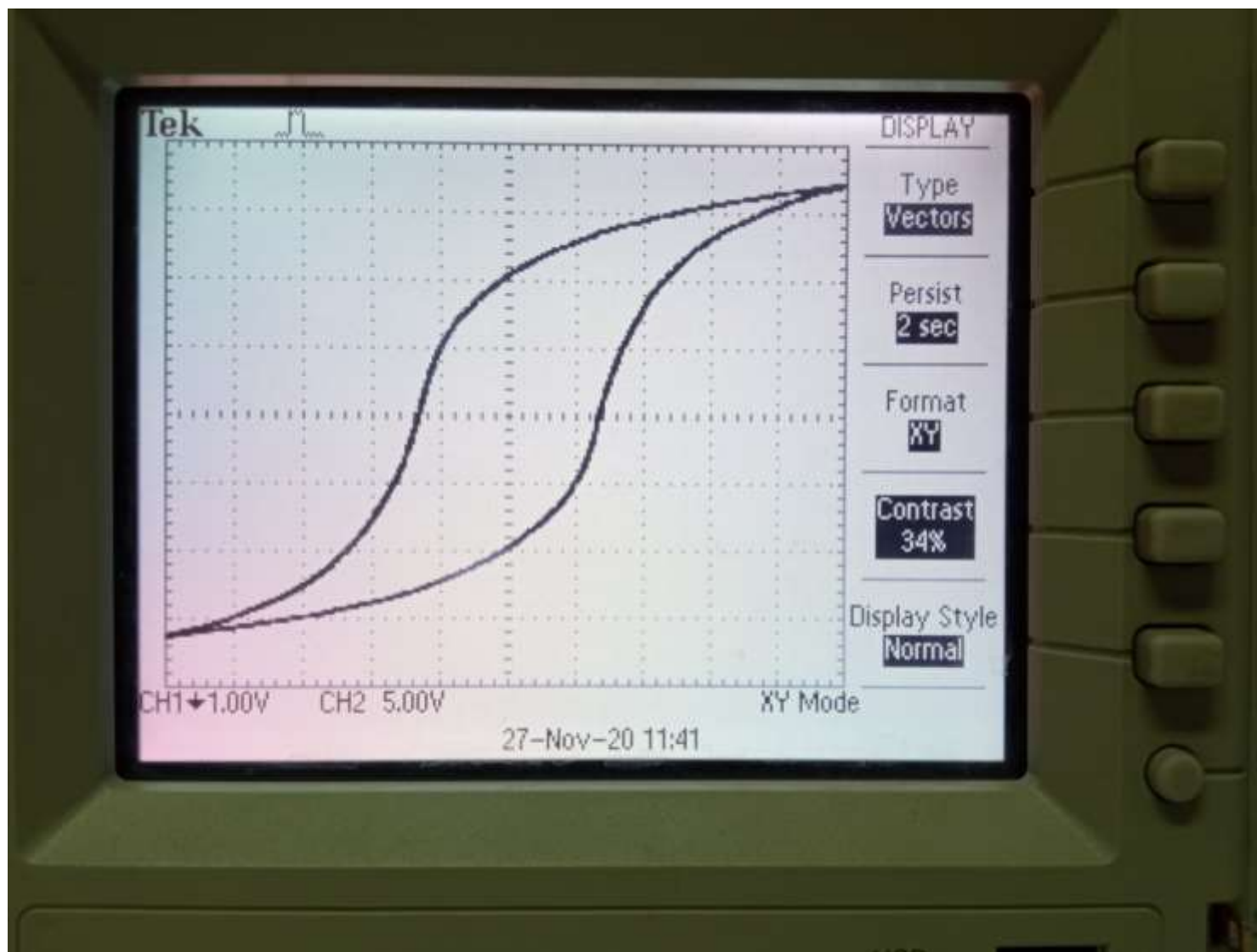
XY režim rada - prikazana je zavisnost jednog napona od drugog: u_2(u_1)
