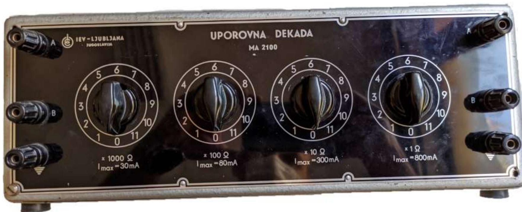
Četiri dekade (x1  $\Omega$ , x10  $\Omega$ , x100  $\Omega$  i x1000  $\Omega$ )
